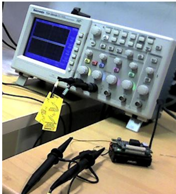
Figura 13: Osciloscópio usado para se estimar o consumo de energia nos estudos de casos
